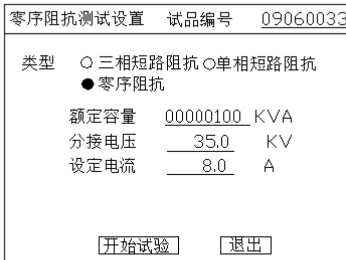
图 12 零序阻抗测试设置界面
