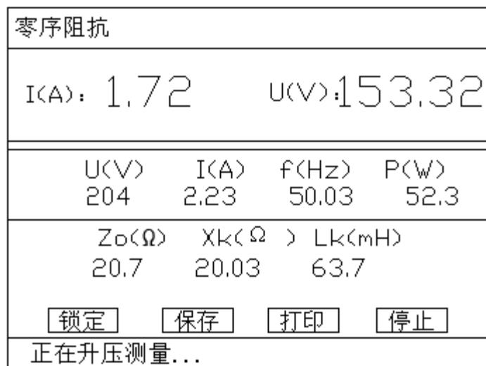
图 13 零序阻抗测试界面
