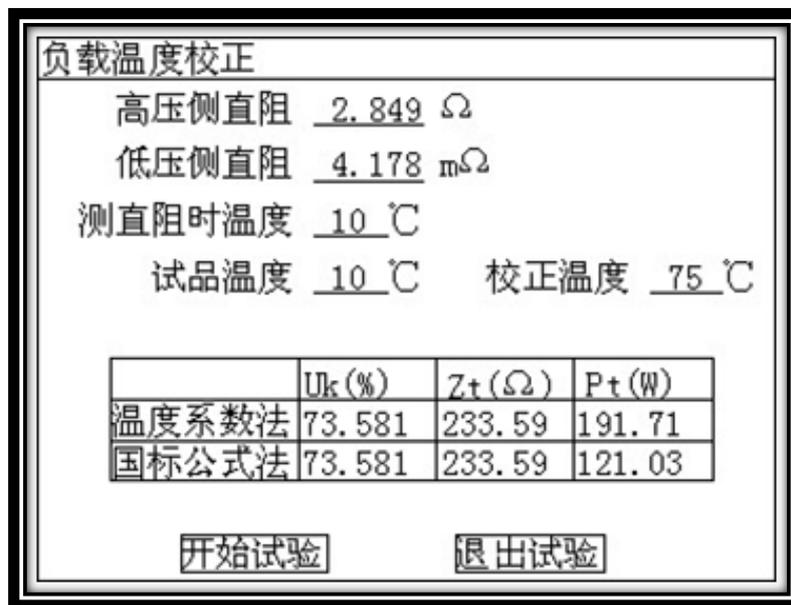
图 12 负载结果温度校正页面
