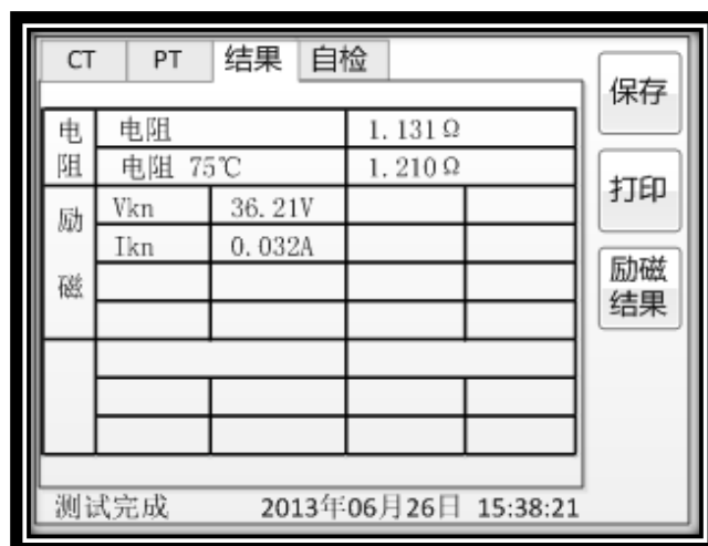
图 2-8 P 级 PT 的试验结果界面
